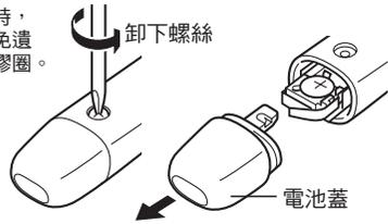
**2** 以不容易彎折的細長物體將電池拆下。
